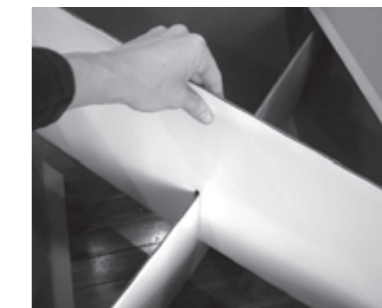
13. Estructura cruz Completar la cruz encastrando la pieza restante en forma diagonal sobre la anterior. Verificar que ambas queden ajustadas a los vértices
