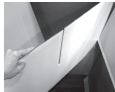
12. Estructura cruz Dentro del display, colocar en forma diagonal, una de las piezas de la estructura cruz, con la ranura hacia arriba
