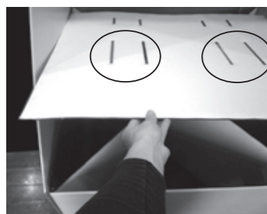
15. Base estantería Ubicar la base sobre la estructura cruz, con las ranuras más largas hacia adelante
