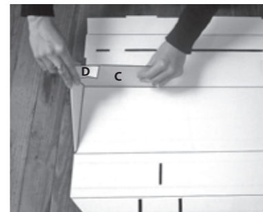
2. Laterales Levantar solapas C y D (en ambos lados del estante)
