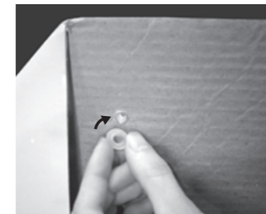
5. Laterales y respaldo Asegurar con arandelas todos los remaches hasta el tope
