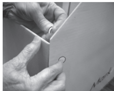
8. Frente Colocar en todos los orificios los remaches por fuera, y asegurar con arandelas por dentro
