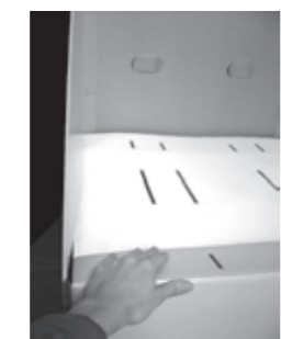
16. Base estantería Ubicar la solapa superior del frente cubriendo la base de la estantería
