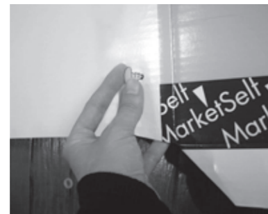
2. Laterales y respaldo Unir ambos laterales al respaldo con remaches plásticos y asegurar con arandela por detrás
